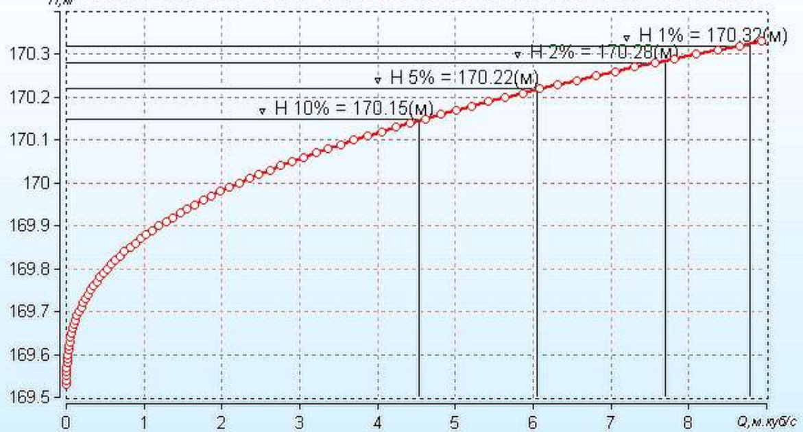
Кривая зависимости Q=f(H) . Створ на балке Горохов Лог (ВЕЧНА)
