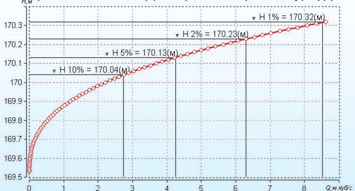
Кривая зависимости Q=f(H) . Створ на балке Горохов Лог (ДОЖДЬ)
